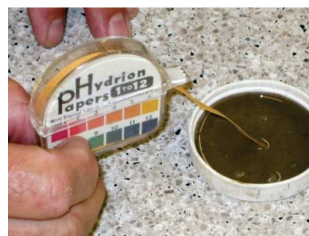
Figure 1 : Détermination du pH d'un échantillon de terre grâce à l'utilisation d'une bandelette pH
