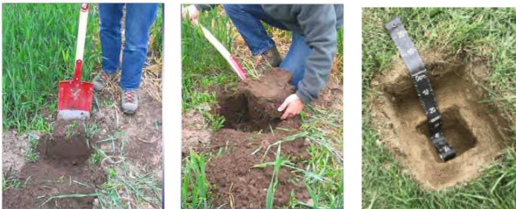
Figure 1 : Étapes d'extraction du bloc de sol à l'aide d'une bêche
