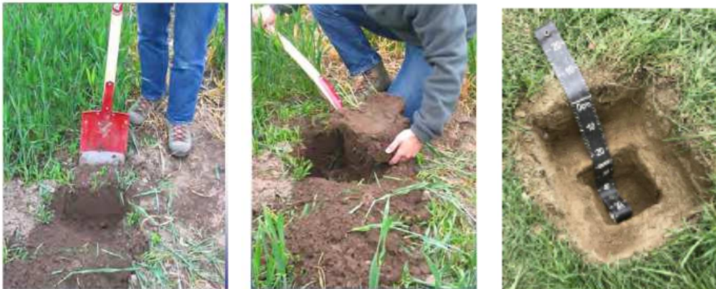
Figure 3 : Étapes d'extraction du bloc de sol à l'aide d'une bêche
